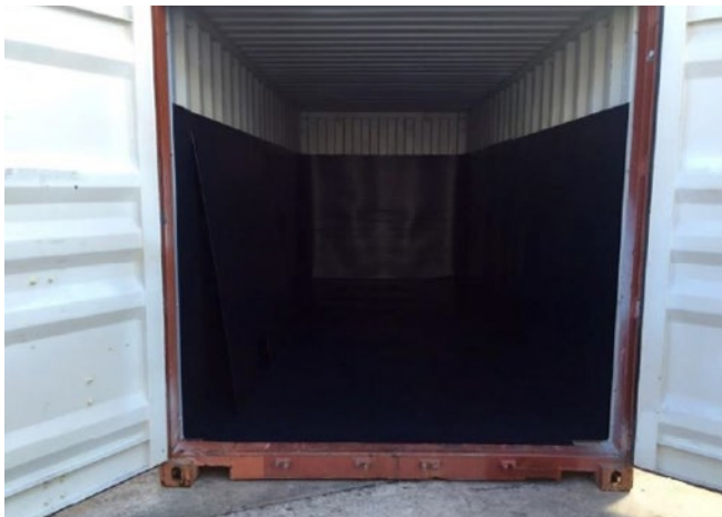
"Lining" para la seguridad del flexibag - Lining to prevent flexibag damages
