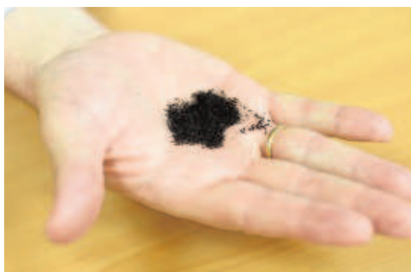
El caucho de los neumáticos se recicla para obtener gránulo
