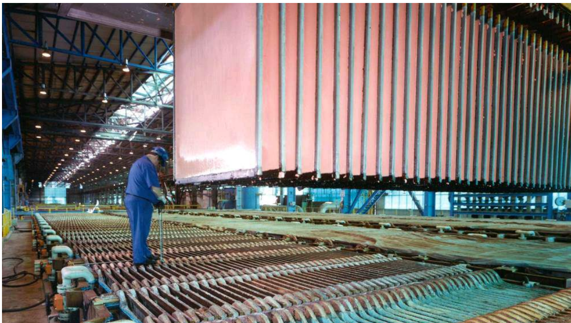
Cátodos de cobre recién salidos de las balsas de electrolisis. (Foto: Atlantic Copper)
