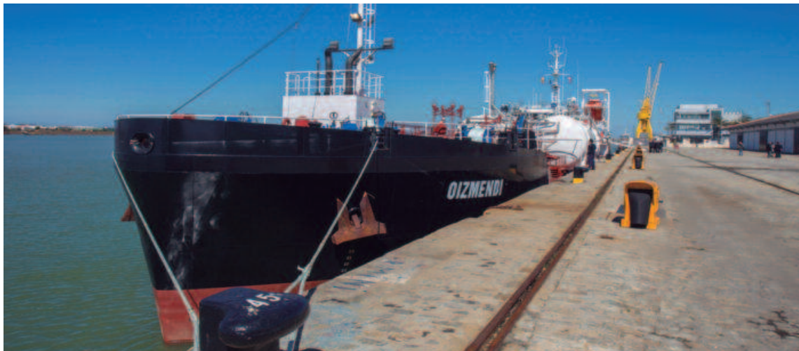
El “Oizmendi” cuenta con una capacidad de carga de GNL de 600 metros cúbicos, 1.900 toneladas de fueloil y 470 toneladas de gasoil.
